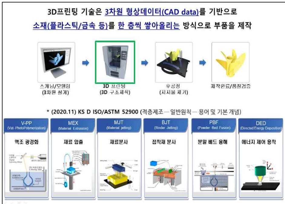
[그림 2] 3D프린팅 공정 절차 및 방식 6)
